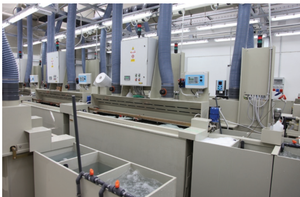
Parte di impianto galvanico realizzato in PP da Fibbi Elio con vasca lavoro attrezzata e corredata di quadro elettrico e vasche lavaggio
