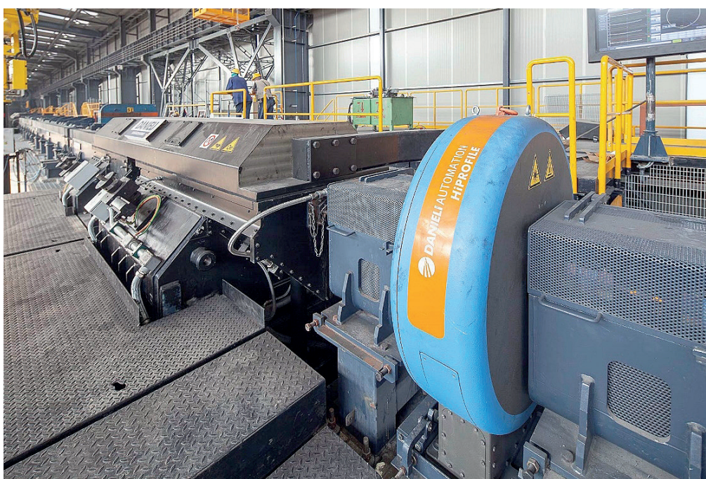
Strumento per il controllo laser del profilo del laminato.
