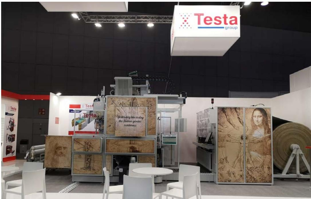
La SuperTestaRossa è capace di tagliare fino a 300 m/min, di eliminare i difetti, i campioni, le cuciture e di imballare fino a 100.000 metri in tre turni
