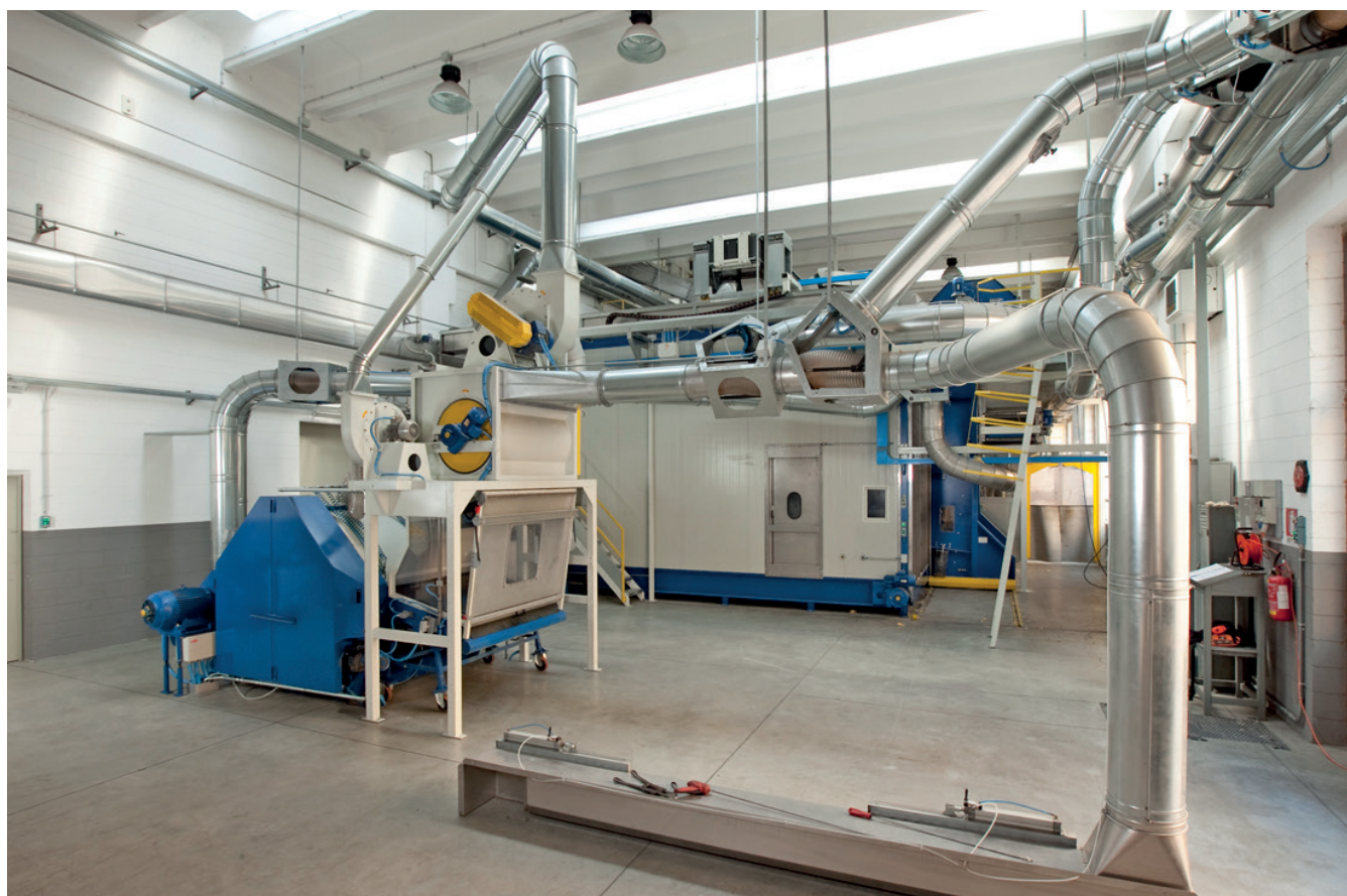
Impianto mescolatura fibre progettato e realizzato da Tecnomeccanica Biellese Blending fibres system designed and built by Tecnomeccanica Biellese
