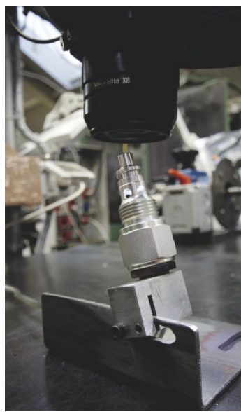
Controllo al 100% dell'eventuale presenza di bava nei fori radiali.
