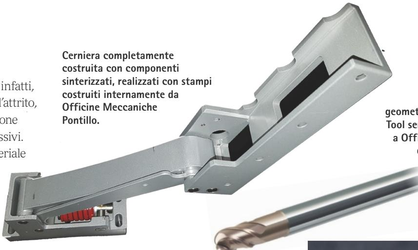
**L'utilizzo della gamma di frese in metallo duro a geometria speciale MMC Hitachi Tool serie EHBB-EHHR permette a Officine Meccaniche Pontillo di eseguire un processo di asportazione veloce, sicuro e ripetitivo su componenti temprati a 62 HRC.**
