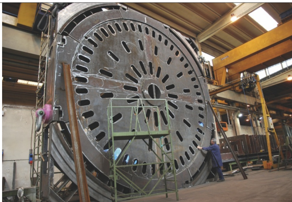
In Delma i singoli pezzi vengono assemblati tenendo conto di tutte le problematiche di deformazione che si potrebbero verificare nelle successive fasi della costruzione del pezzo.
