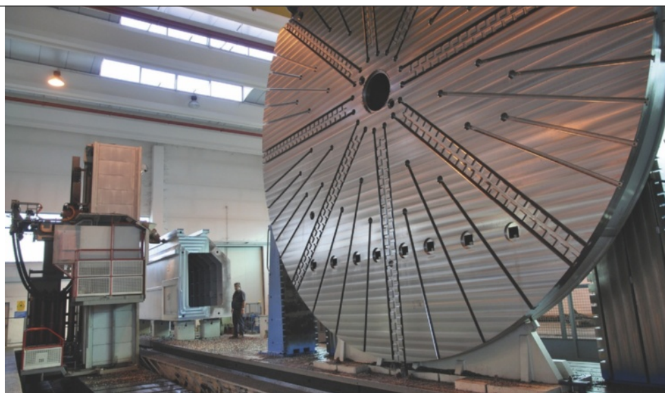
Delma è specializzata nella costruzione di elettrosaldati completi di finitura meccanica e comprensivi di trattamento termico di distensione, sabbatura e verniciatura.
