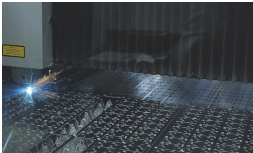
Grazie alla funzione BrightLine fiber, con i sistemi laser Trumpf è possibile ottenere la massima qualità dei bordi e agevolare la rimozione dei pezzi.
