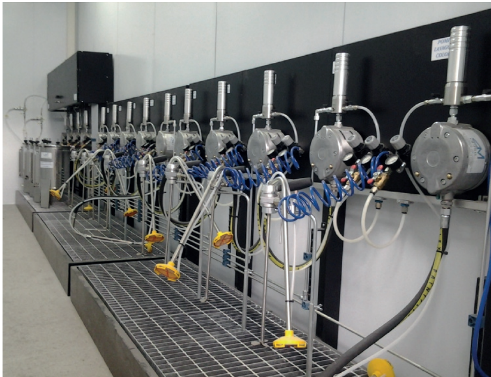
Miscelatore elettronico C.M. Spray Mixer 2011 configurato con 4 catalizzatori a 9 colori.
