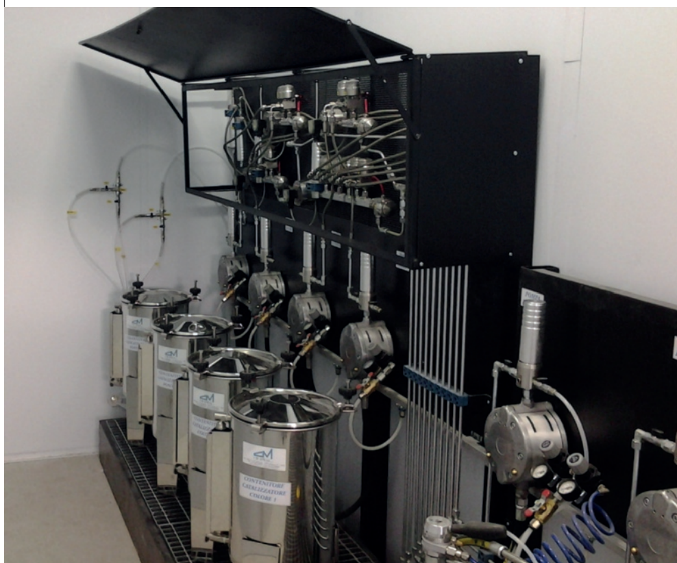
Particolare Miscelatore elettronico C.M. Spray Mixer 2011 con 4 catalizzatori.
