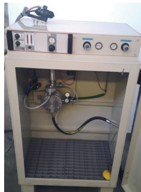
Isobox per sistema elettrostatico automatico vernici base acqua.
