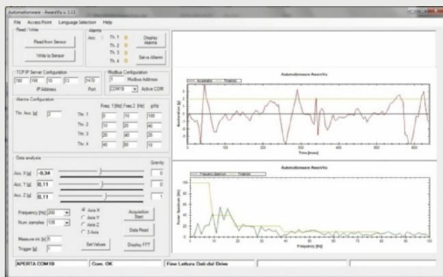
Visualizzazione dell'acquisizione nel dominio del tempo, del dispositivo collegato all'attuatore e la conseguente Fft (dominio della Frequenza), con la visualizzazione delle frequenze di vibrazione principali e secondarie.
