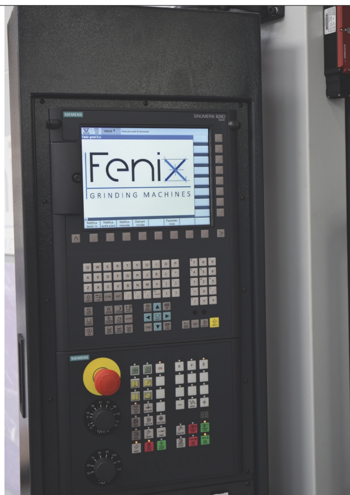
Il Cnc Siemens Sinumerik 828D soddisfa tutti i requisiti richiesti da macchine per la rettifica; lavorazione per la quale include tutte le funzionalità grazie a due canali di processo e sino a 10 assi/mandrini.
