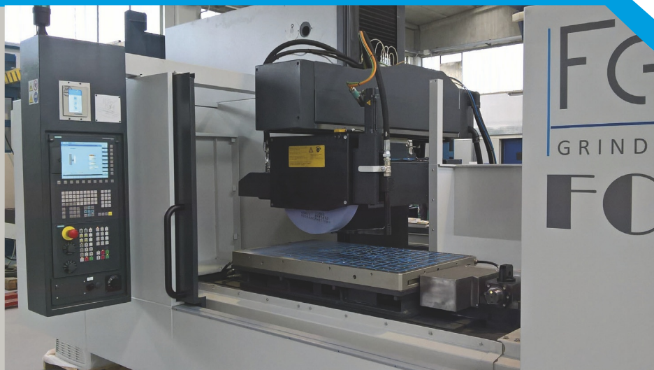
Il Cnc Siemens Sinumerik 828D soddisfa tutti i requisiti richiesti da macchine per la rettifica; lavorazione per la quale include tutte le funzionalità grazie a due canali di processo e sino a 10 assi/mandrini.
