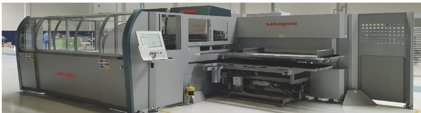
Parte della FlexCell, la cella di piegatura flessibile Salvagnini, anche la pannellatrice modello P4L-2516.
