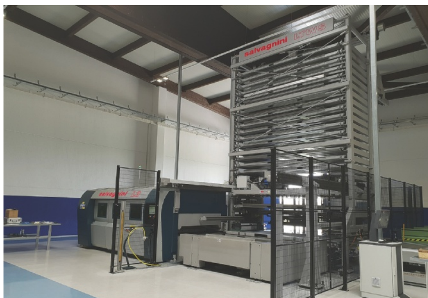
Vista magazzino verticale monotorre LTWS, dotato di 15 vassoi di carico in grado di alimentare automaticamente l'impianto di taglio laser a fibra L3 da 3 kW.
