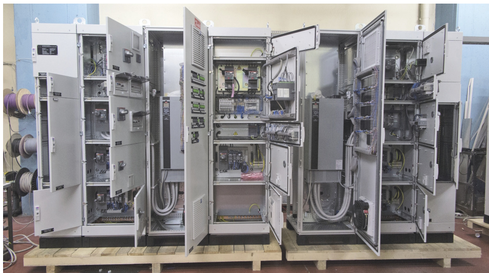
Quadri destinati alla stazione denominata "FBA" in Frederiksberg Allé, appena collaudati presso il reparto di produzione della H.S. Progetti e in attesa di essere imballati.
