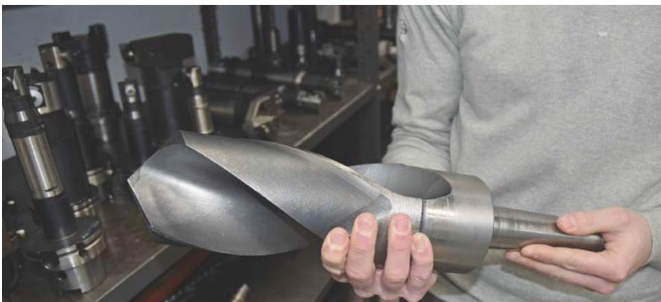
Punta conica Nui in esecuzione speciale, cono ridotto e lunghezza prolungata rispetto allo standard della Din 345.
