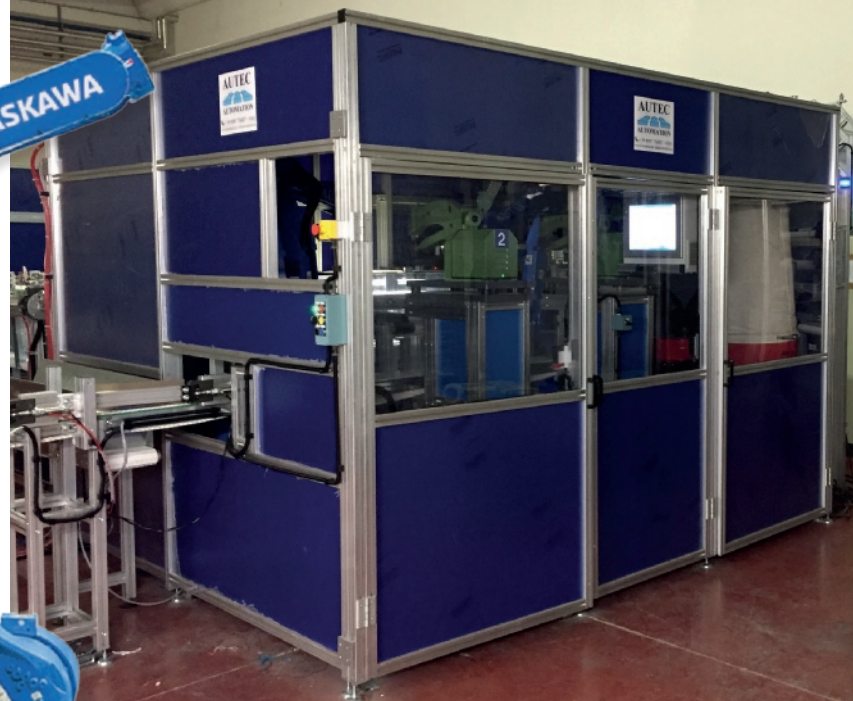
L'impianto progettato e realizzato da Autec Automation ha permesso al proprio cliente di rendere completamente automatizzata l'operazione di rifilatura/sbavatura suole
