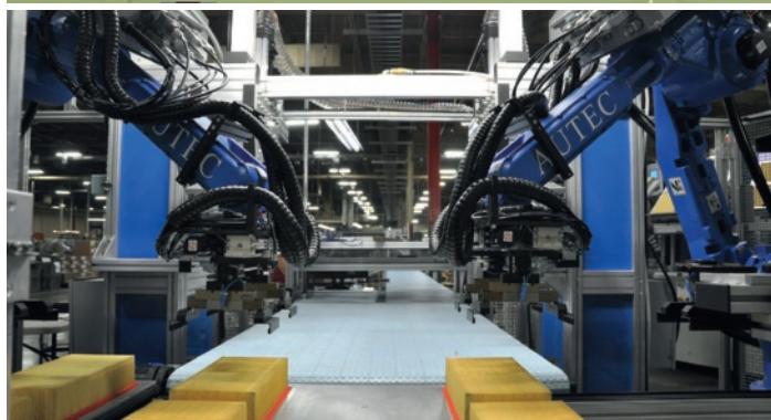
Impianto per la rifinitura/sbavatura di filtri aria per automotive dove trovano applicazione robot Yaskawa
