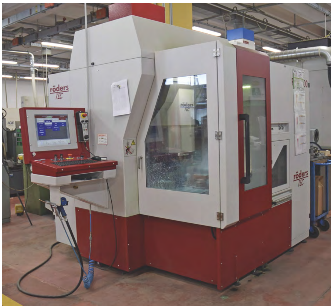
Presso lo stabilimento di S. Maria di Sala (VE), Safilo utilizza per la realizzazione dei propri stampi la fresatrice RXP 500 della tedesca Röders.
