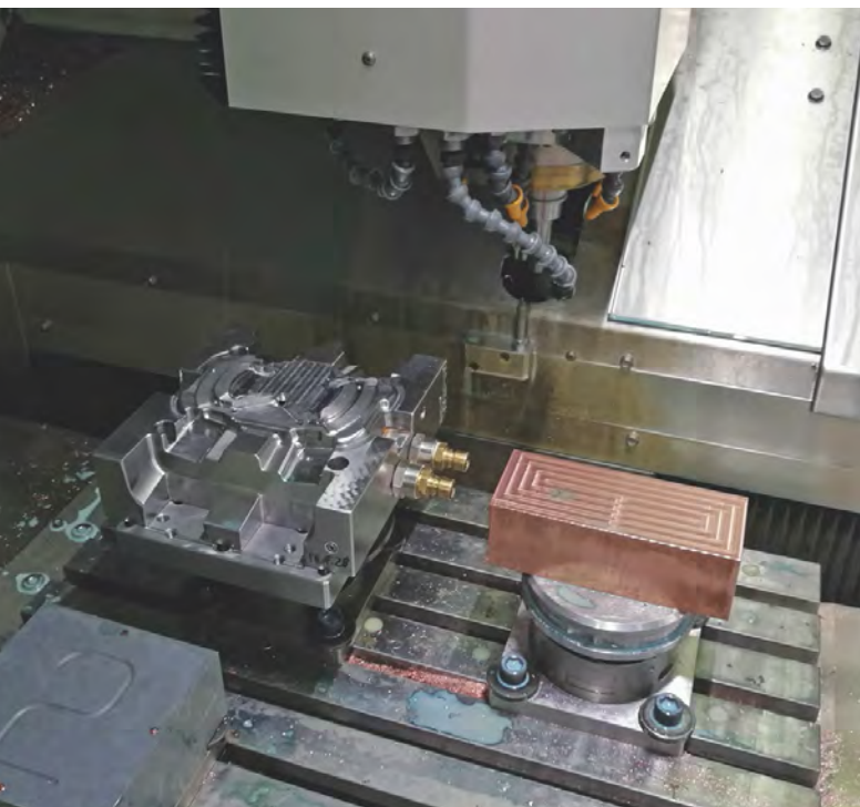
Dettaglio di lavorazione sulla fresatrice Rödgers RXP 500, utilizzata sia per elettrodi che per fresatura diretta sul temprato.
