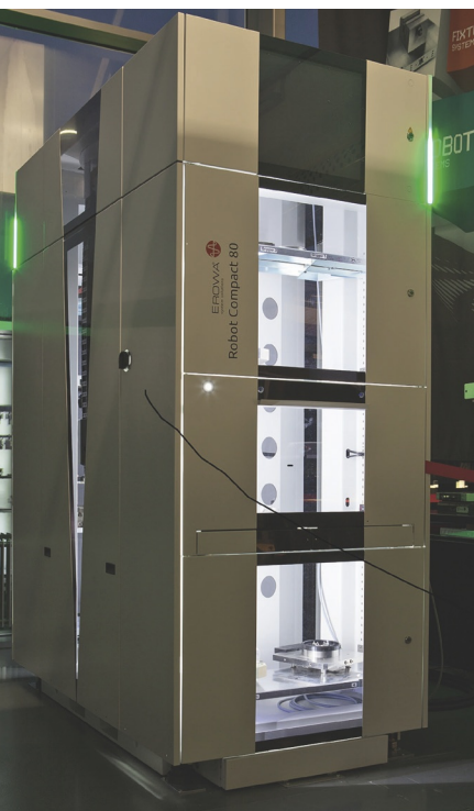
Con la cella Erowa Robot Compact ERC 80 si possono alimentare e gestire fino a due macchine con un ingombro molto ridotto.
