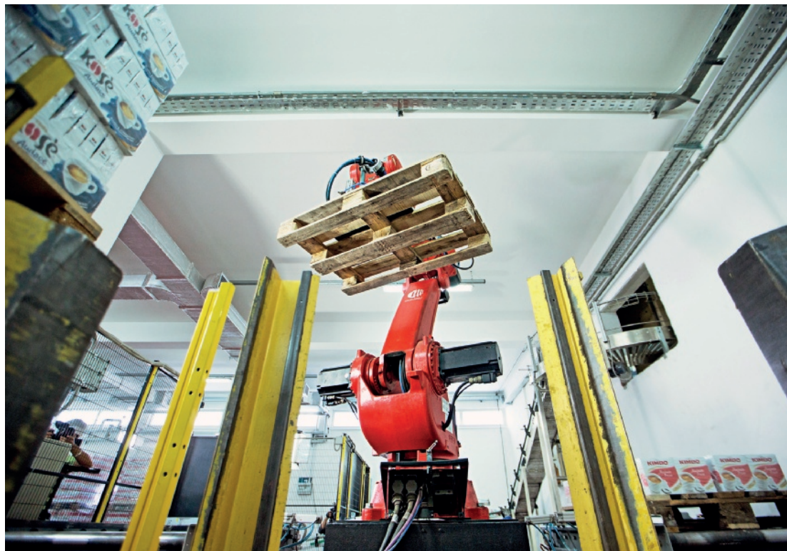
Nonostante gli spazi limitati (anche in altezza), la soluzione Comau adottata si è rivelata vincente e soddisfacente dal punto di vista produttivo, di raggiungibilità, portata e "cadenza/tempi ciclo"
