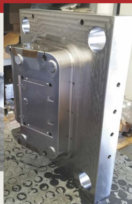
Stampo realizzato da iMold con piastre integrali normalizzate Hasco, acciaio 1.2311, per consolle di apparecchiatura industriale. Sopra, il pezzo stampato.
