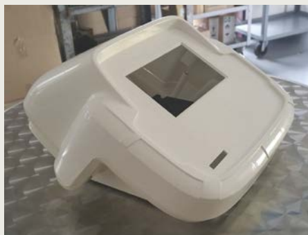
Stampo realizzato da iMold con piastre integrali normalizzate Hasco, acciaio 1.2311, per consolle di apparecchiatura industriale. Sopra, il pezzo stampato.
