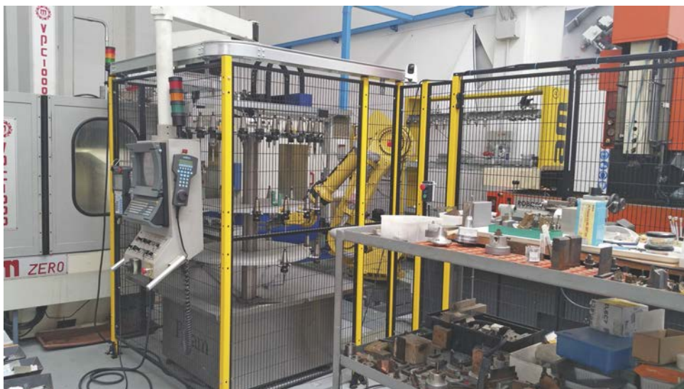
Altamente automatizzata, iMold si avvale di un'isola robotizzata dove operano (senza presidio) due centri di lavoro e un centro di elettroerosione a tuffo.
