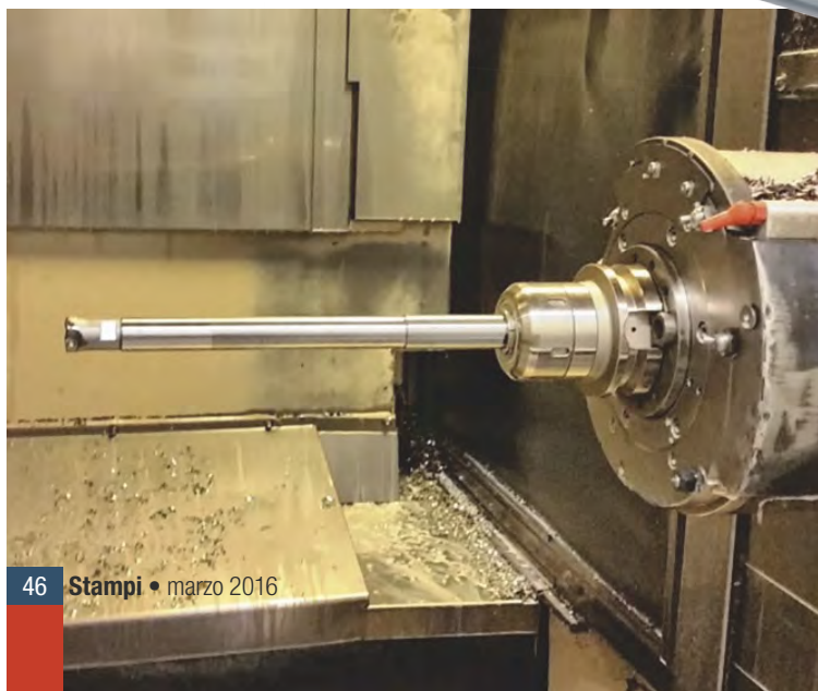
Una delle ASRF diametro 25 mm impiegate comunemente nelle lavorazioni ad elevati sbalzi utensile (300 mm).
