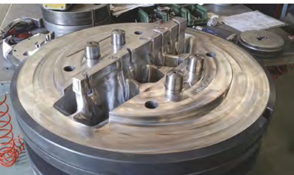
Mandrino di porthole per estrusione di profili industriali in alluminio.
