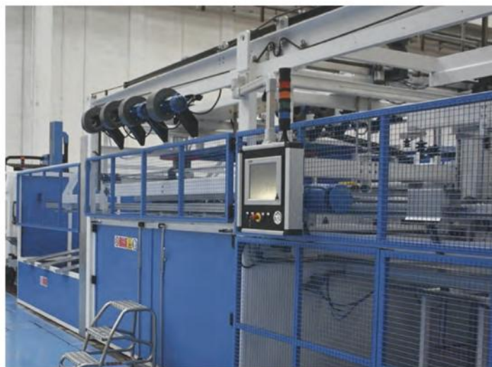
Particolare della linea di termoformatura e taglio sviluppata da Comi per la produzione di un sottoscocca per SUV
