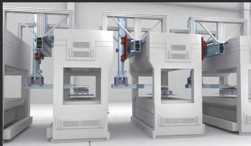
Esempio applicativo di sistema di azionamento telescopico inter-prensa customizzato da Rollon al servizio dell'automazione della lamiera.
