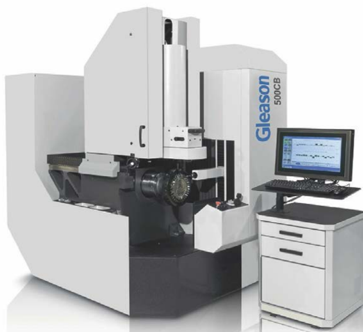
Gleason 500CB, nuova macchina per montaggio automatico delle frese per coppie coniche.
