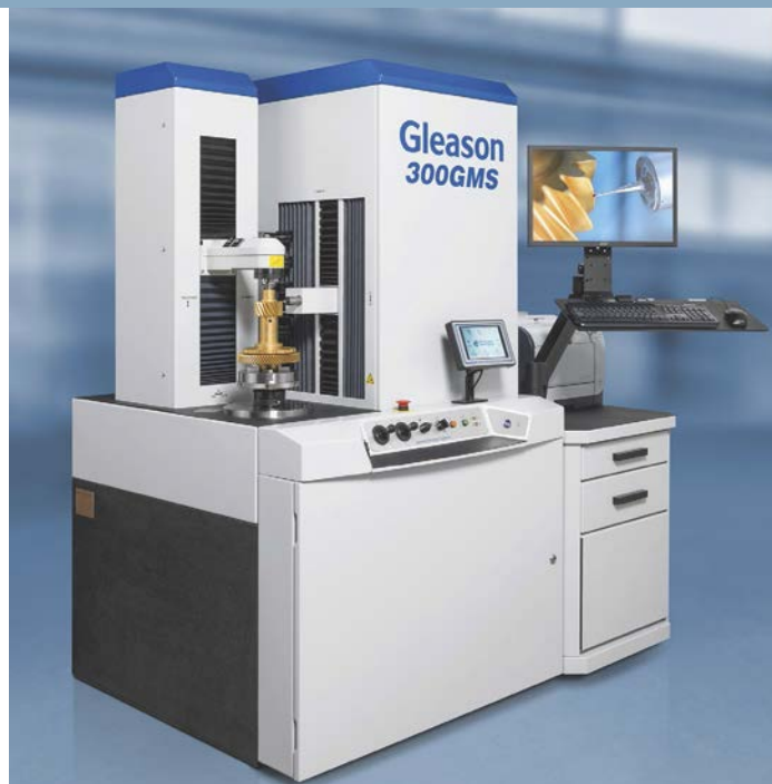
Ad affiancare il noto evolventimetro 300GMS, Gleason ha recentemente rilasciato sul mercato anche la nuova versione denominata 300GMS P, indicata per la misurazione in officina di ingranaggi cilindrici, conici, di utensili e di particolari prismatici.
