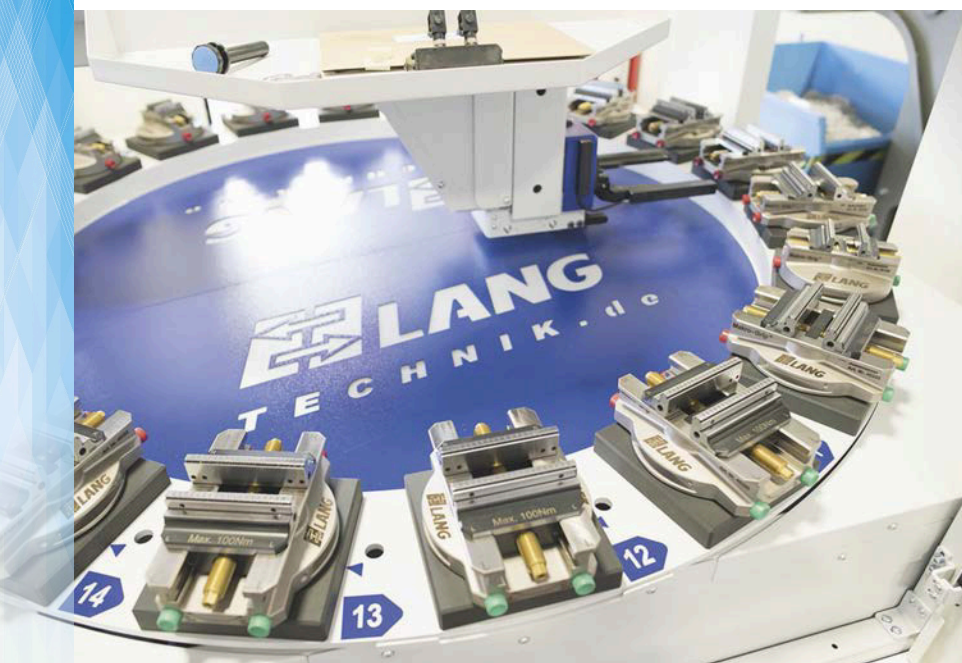
Vista di uno dei quattro pallettizzatori Lang Eco-Compact 20 da 20 slot.
