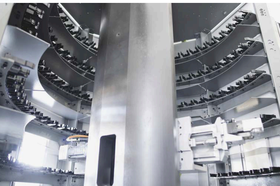
I nuovi centri di lavoro acquisiti da Weerg dispongono di 234 utensili ciascuno.
