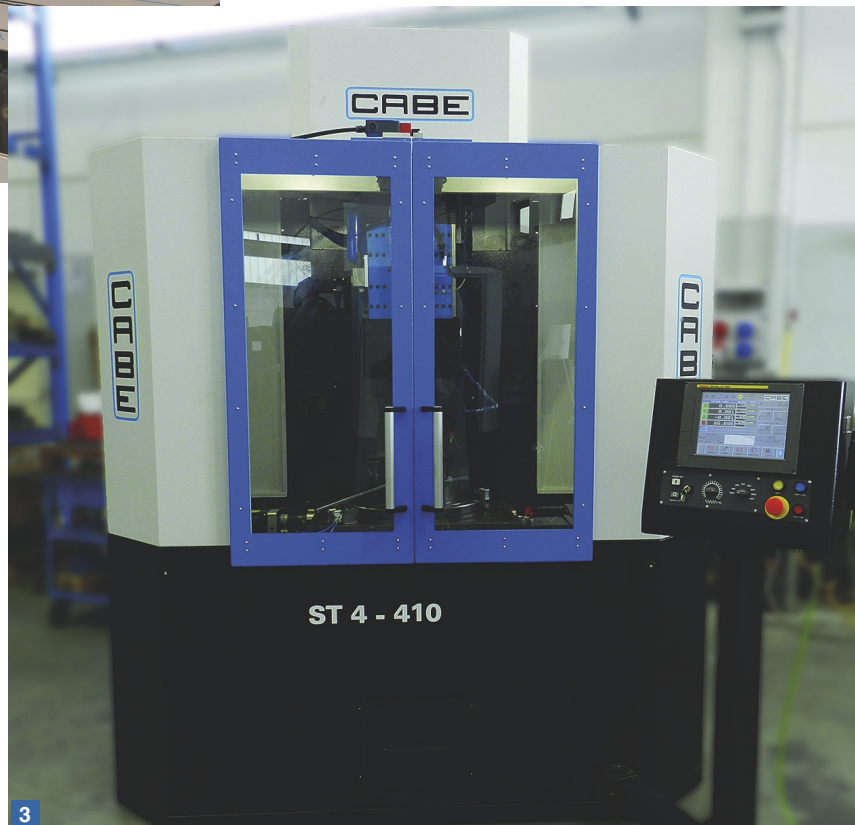
Fig. 3 - Il gruppo BR1 progetta e produce macchine utensili tra cui anche la nuova Cabe ST4 Cnc, stozzatrice con movimentazione controllata di 4 assi.
