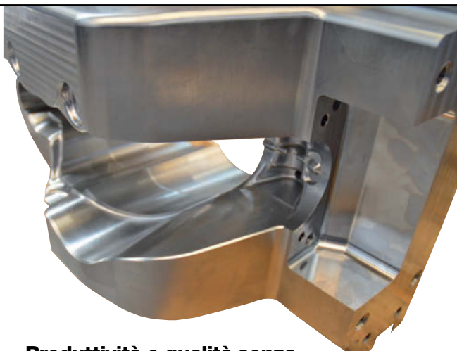
Dettaglio vista stampo per componente automotive con tasche profonde e sporgenze importanti, lavorato interamente con frese MMC-Hitachi Tool.
