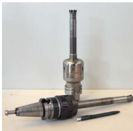
Aspv mini assemblata con steli in metallo duro e mandrini forte serraggio OH 165 e OH 250.
