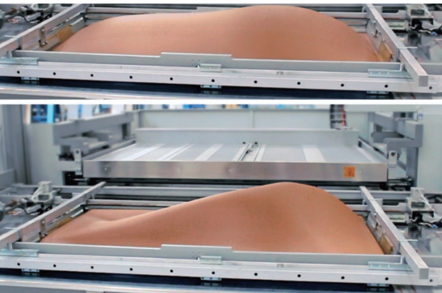
Durante la termoformatura la lastra termoplastica, in questo caso di materiale Ripanel, subisce un rammollimento che permette di accogliere la forma definita della dima
