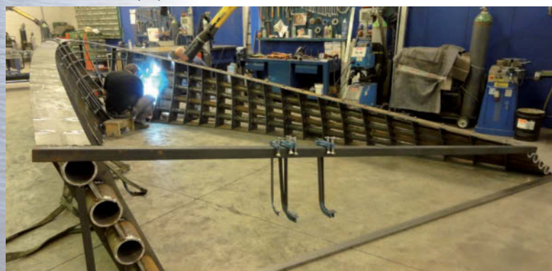
Fig. 2 - Una fase della lavorazione della sottostruttura in acciaio all'interno dello stabilimento di Metal-Sistem di Cantù (CO).
